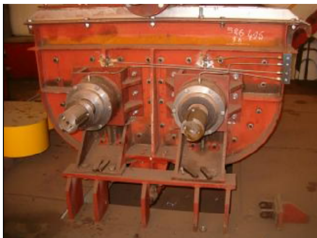
Foto 1- Malaxorul de beton, partial echipat
